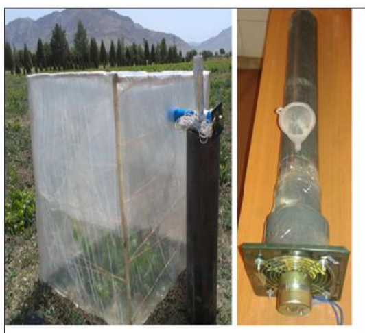
شکل ۱- سیستم خزننده بوته‌های مو در ایستگاه تحقیقات انگور ملایر (الف) و نحوه پاشیدن گردوخاک روی بوته‌های مو به کمک دستگاه مکانیکی (ب)
